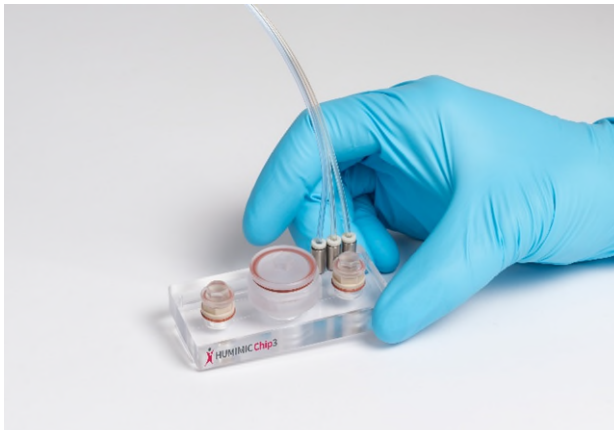
Abb. 2 Der Multiorgan-Chip der TU Berlin und von TissUse besteht aus drei Kompartimenten, die durch Mikroflüssigkeiten verbunden sind. Das mittlere enthält ein Lungenmodell, sprich Zellproben. In einem weiteren Kompartiment befindet sich ein Lebermodell.
