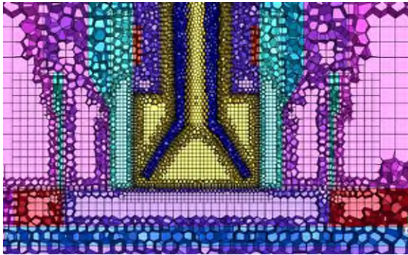
Abb. 1 Rechengitter für die thermische Simulation mit einer vergrößerten Darstellung des Expositionsgeräts NanoCube. In Gelb sind die Aerosolbereiche, die anderen Bereiche sind entweder Bauteile oder Luftbereiche.
